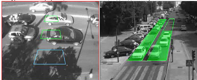
Фигура 7.1: Информационен и засичащ видео-детектор
