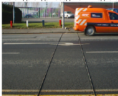
Фигура 7.7: АТС системи – автоматични броячи. Могат да бъдат обединени в една обща система.
