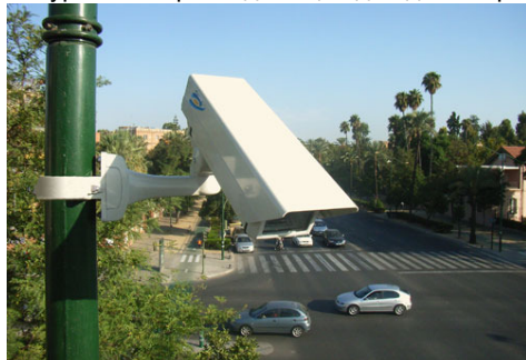
Фигура 7.2: Проследяващ видео-детектор
