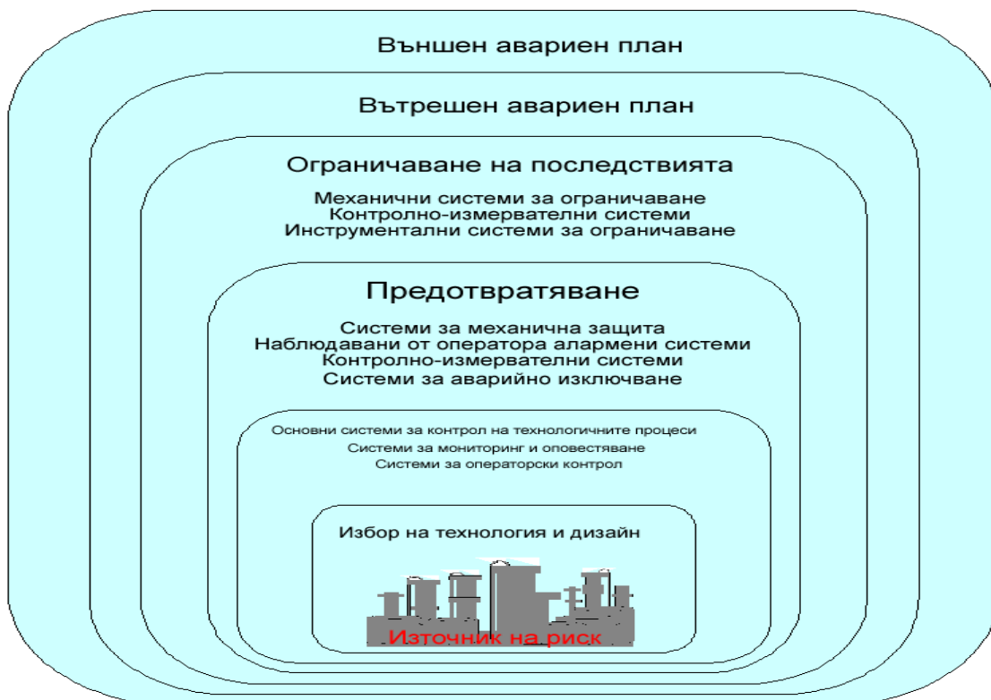
Фиг. 1 „Нива на безопасност” за технологичния процес
