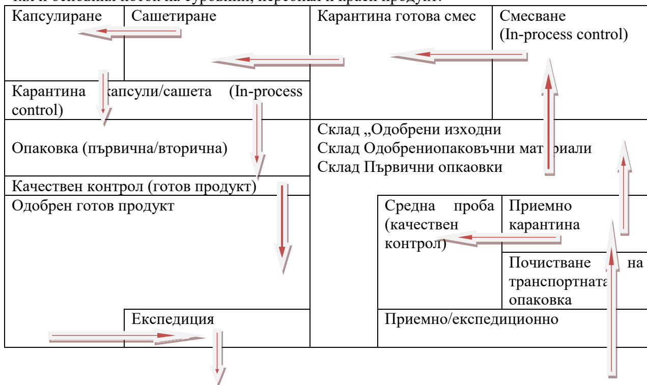
Диаграма 2: Общо представяне на видовете помещения, функционалната връзка между тях и основния поток на суровини, персонал и краен продукт:
