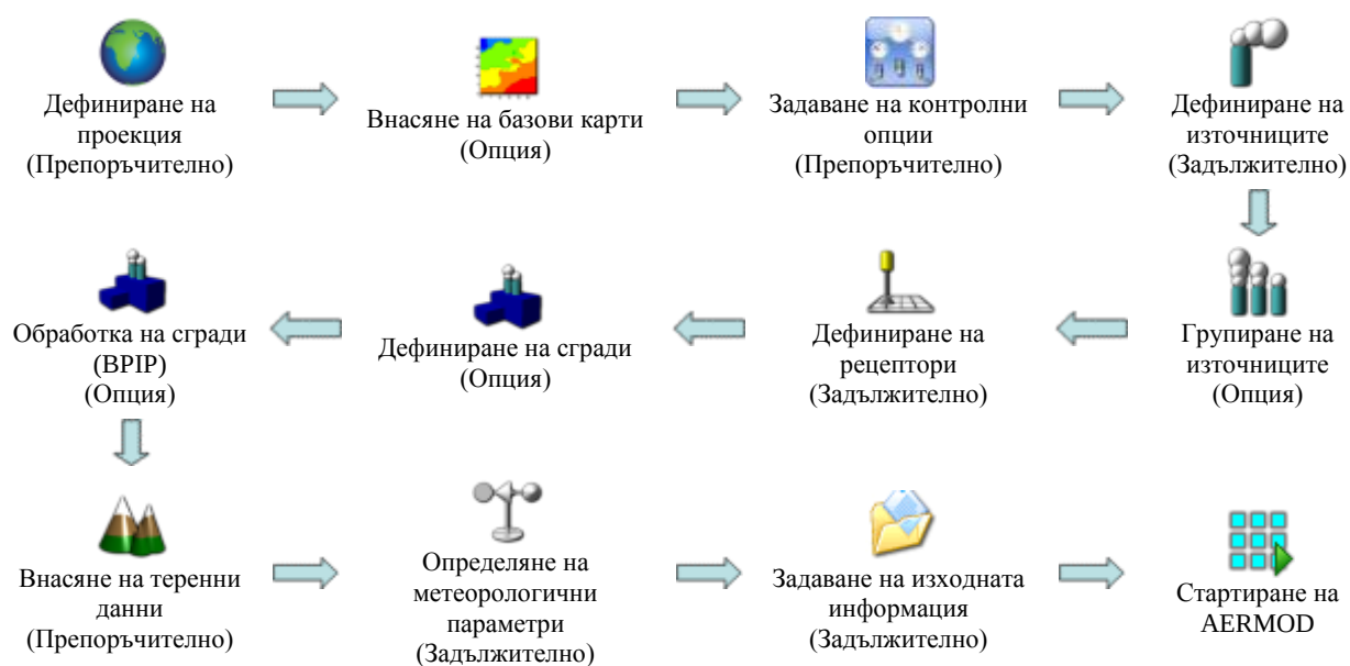
Фигура 4.49 Последователност на работа с модела AERMOD
